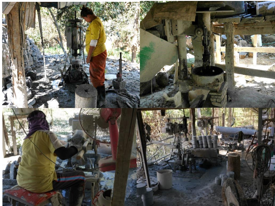
ภาพที่ 3.25 รูปแบบการผลิตครกหิน โดยใช้เครื่องจักร จะมีเครื่องควั่น และเครื่องตัดเฉือน เพื่อให้เกิดรูปทรงกระบอกของครก ทำการตัดเฉือนให้เกิดเป็นรูปทรงกรกแล้วทำการการสีกัดด้วยมืออีกครั้ง เพื่อกะเทาะหินให้หลุดออกมาเป็นครกตามแบบที่ตัดเฉือนไว้ (ลงชุมชนวันที่ 30 มีนาคม 2564)
