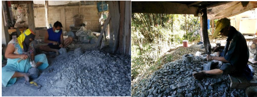
ภาพที่ 3.23 รูปแบบการผลิตครกหินด้วยมือจะต้องใช้วิธีการสีกัด และกะเทาะหินออกมาเป็นชิ้นเล็กๆทำให้เศษหินที่ได้จะมีขนาดที่เล็กและเป็นแผ่น ไม่สามารถนำไปใช้ประโยชน์ได้ รวมถึงขณะเวลาสีกัดนั้นหินจะถูกกดเฉือนลงไปอย่างแรงทำให้หินดีดออกไปเร็วและแรง จึงต้องสร้างกำแพงกันทางด้านหน้าประมาณ 2 เมตร หรือสีกัดในที่โล่ง เพื่อมิให้หินดีดกลับมายังผู้ผลิตทำให้เกิดอันตรายได้ (ลงชุมชนวันที่ 30 มีนาคม 2564)
