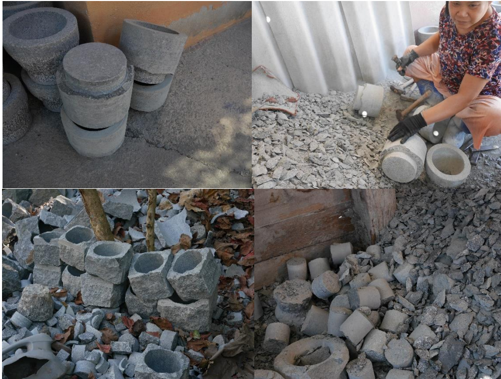
ภาพที่ 3.26 ภาพหินที่ใช้เครื่องจักร ในการคว้าน และตัดเฉือน จะเกิดรูปทรงที่เป็นภาพรวมของครกหิน ก่อนนำไป สกัดด้วยมืออีกครั้งเพื่อให้เกิดเป็นครกหินและทำการตกแต่งให้สมบูรณ์ โดยในการใช้เครื่องจักรนี้จะทำให้เกิดเศษหิน ที่ได้จากการคว้านและการตัดเฉือนเป็นชิ้นขนาดใหญ่ ทั้งการคว้านหินออกมาเป็นเป็นทรงกระบอกกลวง(จากหินที่ นำมา) และเศษหินที่เป็นทรงกระบอกตันจากแกนตรงกลางครก ซึ่งสามารถนำไปใช้ประโยชน์ได้ (ลงชุมชนวันที่ วันที่ 10 เมษายน 2564)
